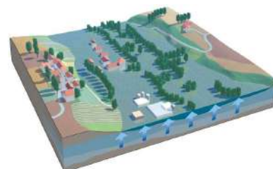
Inondation de nappe
